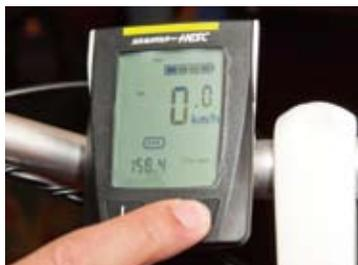
▲只要拆卸下LCD控制面板，電動車即無法啟動，具有簡易的防盜功能。
