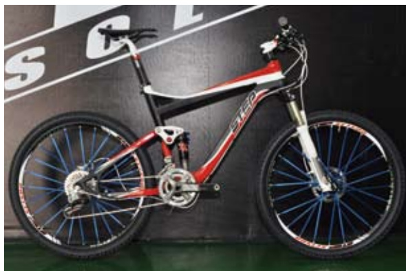
▲黃總經理自行設計的碳纖維全避震登山車架，以輕量化為設計訴求，搭載Sram XX僅重10.5kg。
