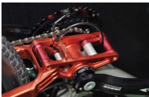
▲黃總經理自行設計的登山車架，搭載SVPP多連桿技術，騎乘中不減少動能、相較同型車款重量減少500g，而且在彈跳中可以維持後下叉的區間，進而不會影響變速性能。
