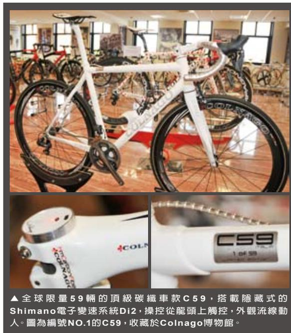
▲全球限量59輛的頂級碳纖維車款C59，搭載隱藏式的Shimano電子變速系統Di2，操控從龍頭上觸控，外觀流線動人。圖為編號NO.1的C59，收藏於Colnago博物館。
