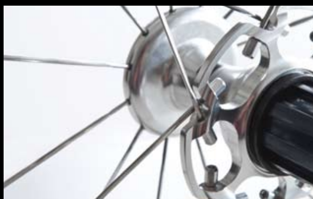
3T一鳴驚人的革命性碳纖維輪組MERCURIO (tubular) LTD 60，獨家銅頭反向置入設計，幅條需微調，不需將管胎拆卸，獨樹一格。僅1,390g。
