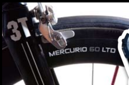
3T一鳴驚人的革命性碳纖維輪組MERCURIO (tubular) LTD 60，獨家銅頭反向置入設計，幅條需微調，不需將管胎拆卸，獨樹一格。僅1,390g。
