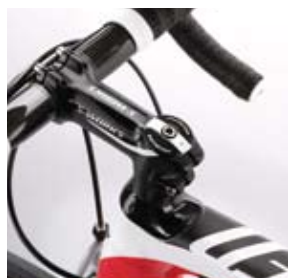
▲整合式頭管上蓋能夠幫助降低風阻，幫助你一臂之力！
