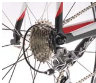
▲Venge 的後變速線於後勾爪的位置穿出，讓外觀散發簡潔流暢的氣息。
