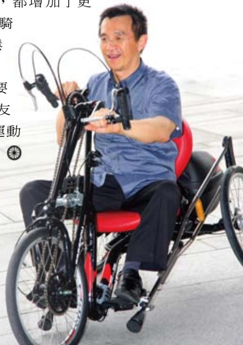
►「Freedom 1號」以雙手運動代替原本的雙腳踩踏運動，並且是第一輛可以倒退的身障自行車，很多實用貼心的功能設計皆來自台中市副市長徐中雄的建議方式。
