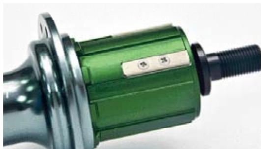
▲花殼轉動套筒採複合材料，套筒上嵌入補強片，與棘輪的驅動力可更直接。
