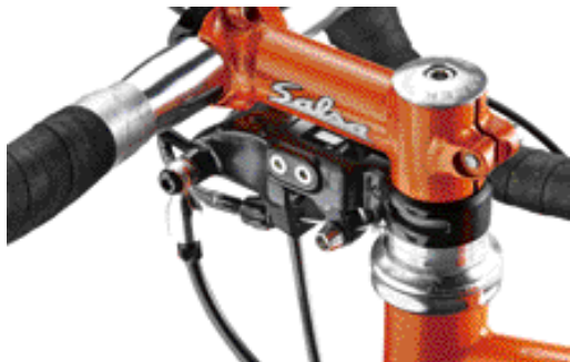
▲Parabox裝置於豎管下方，設計理念為不干涉現有的車款配置，並且擁有方便安裝與調整的功能。
