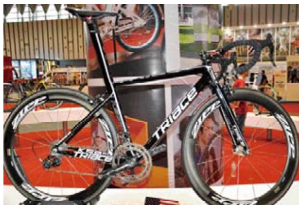
▲離馳KS930車架採用Toray T700高模量碳纖維原材料。
