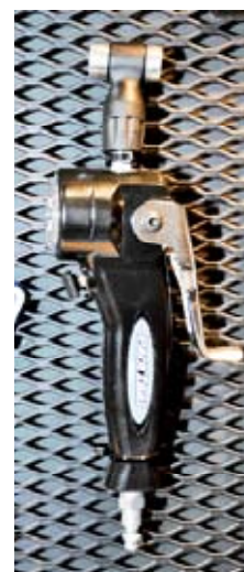
▲Park Tool Shop Inflator裝置採用雙頭式汽嘴設計，可適用於美式嘴與法式嘴，讓打氣時變得迅速又方便，搭配的胎壓計可以顯示0-160psi。
