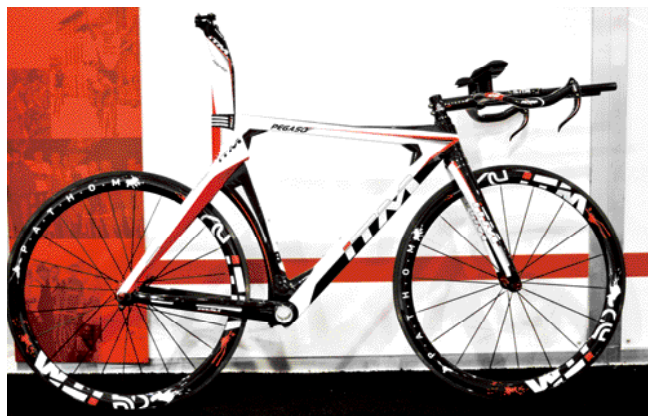
▲ITM Pegaso TT車架預留隱藏式和Di2走線設計，其中Seat Post可提供75和78兩種角度，滿足不同的騎乘姿勢。
