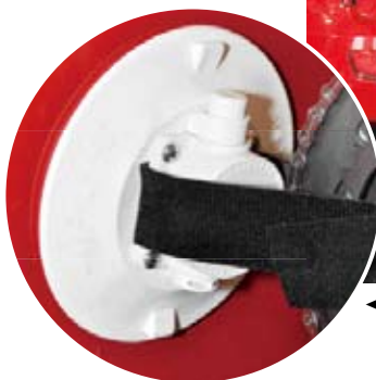
◀Tern Link系統是在上管加裝一個可以放置座桿的裝置，讓你在折疊之後將座桿插入，即可輕鬆拖著走。
