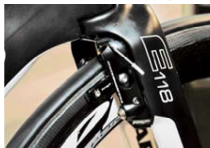
▲TRP持續專注將煞車夾器與前叉和車架完美結合，希望創造更加簡潔的視覺效果與低風阻效果。
