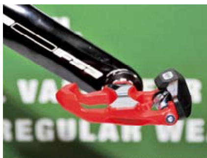
▲Wellgo磁性自動復位系統，可以讓踏板維持特定角度，初學者再也不用擔心找不到上卡角度。
