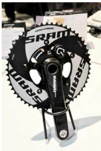
▲Sram Quarq Cinqo Stator提供標準盤與CT盤款式，利用Ant+傳輸到智慧型手機顯示功率、迴轉數與力矩等資訊。
