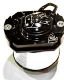
▲VP Varial可調整角度車頭碗組為無段式設計，擁有弧形培林，可調整正負1.5度，縮短軸距讓操控佳、拉長可以增加穩定性，適用於FR和DH路況，重量186g。
