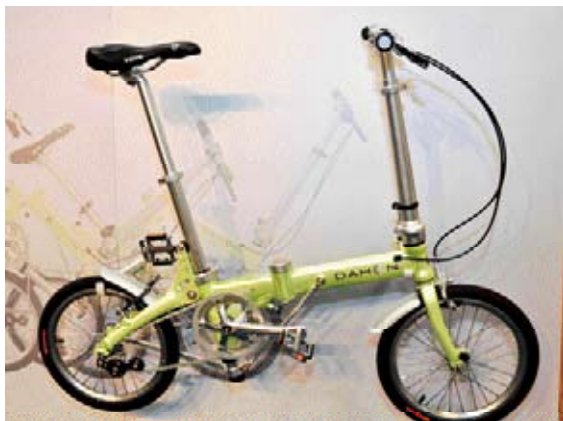
▲Dahon Jifo 16 堪稱3秒內輕鬆折疊與展開，踏板可放置於後方，減少折疊空間，折疊後體積為60X25X59 (mm)，採用隱藏式走線設計與後腿方便收縮功能，僅重8.95kg。
