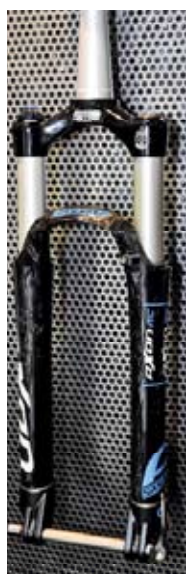
◀FOX 34 Float 29（左）避震行程140mm，Talas29（右）避震行程為140與100mm，擁有可鎖死與預壓等功能。
