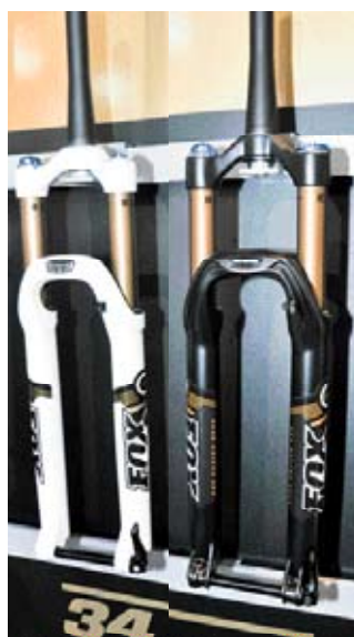
◀FOX 34 Float 29（左）避震行程140mm，Talas29（右）避震行程為140與100mm，擁有可鎖死與預壓等功能。
