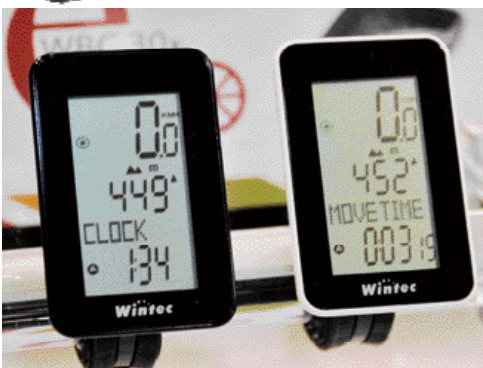
▲Wintec WBC-300車表擁有高度、迴轉速、速度和距離等15種功能。
