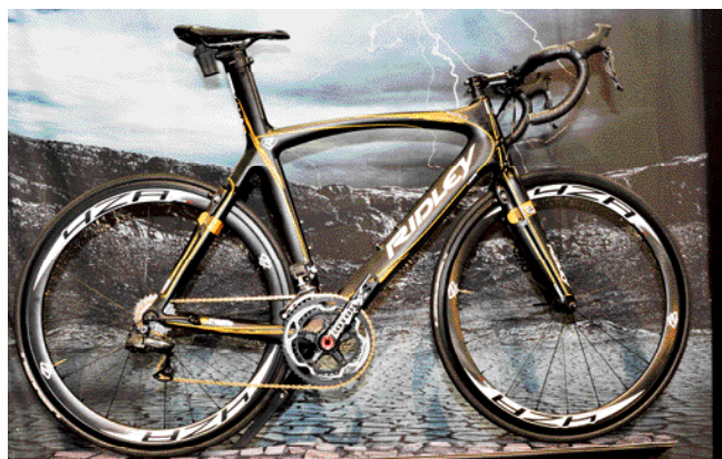
▲Ridley Noah FB強調空氣力學設計，將煞車夾器與前叉後上叉完全結合，並且加強前叉的空氣導流功能，達到降低風阻的目的，整車僅重7.03kg。
