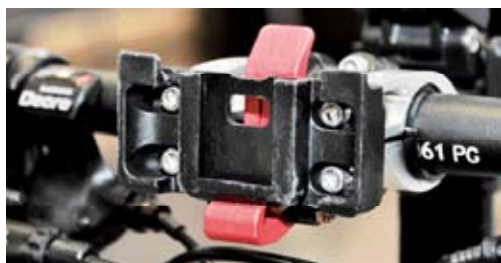
◀T-one Talon快扣裝置安裝於車把手前方，可對應相機包、貨架與萬用包，讓你依照不同的騎乘需求輕鬆選擇需要的「百寶箱」。
