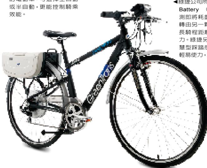
◀綠捷公司所研發的Dual Saddle Battery (DSB)，可以自動偵測即將耗盡的電池，而自動轉移由另一顆電池供電，不但加長騎程距離，更可有效節省電力。綠捷另外發表的產品為智慧型踩踏感應系統，騎乘者可輕易使力，輕鬆駕馭自行車。
