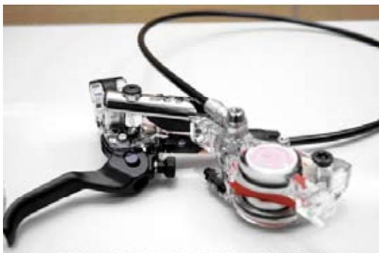
▲特別製作的透明版油壓碟煞，能明白透視其作動結構。
