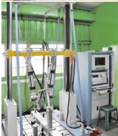
◀ ▲ EN 車架測試設備與各式各樣的治具，可以針對 EN 各試項目進行試驗，本款機台規格與 SGS 相同。
