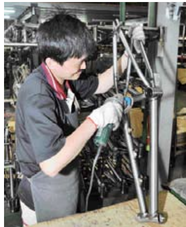
◀ ▼ 在鋼管車架產製過程中，無論是焊接、修邊等過程，都有專員負責，提高生產效率。
