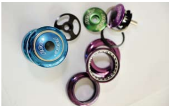
▲一般的鐵製產品都是黑色或銀色，NECO推出鐵製的車頭碗組藉由彩色電鍍的方式達到Colorful，可以提供各式各樣的顏色。
