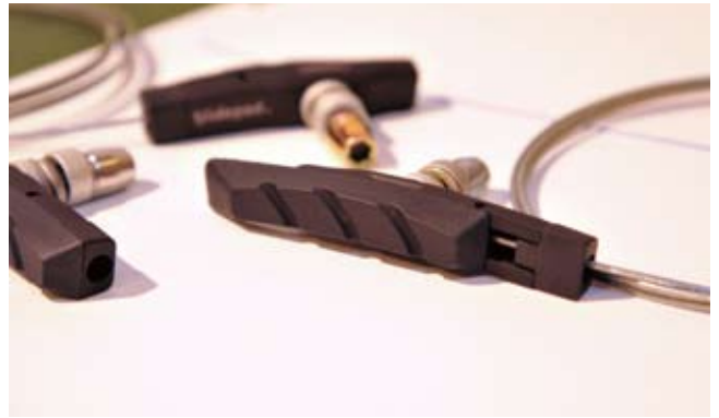
▲Slidepad安全煞車塊透過單邊後煞車塊的錯動式設計，讓前煞作動慢於後煞，避免不熟悉煞車系統而產生危險。
