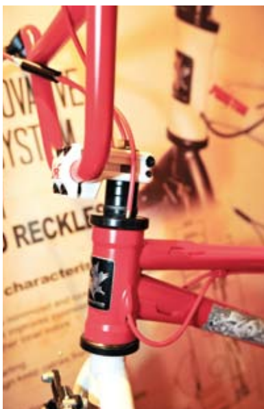
▲元城Flight-R擁有發明專利設計，它是將前後煞車管線整合於頭管之中，透過內部旋轉器讓專業選手在表演特技時可以盡情自由360度旋轉車把手。
