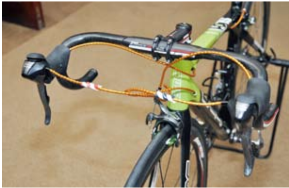
▲Alligator ilink是採用鋁合金材質，可以自行調整適合的長度與角度，讓煞車內線與變速內線在作動時有如潤滑油般的順暢。
