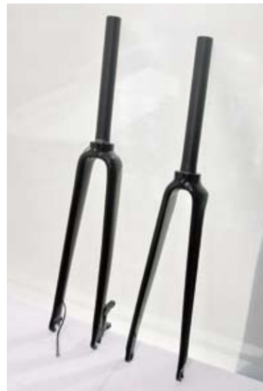
▲RST利用液壓成型技術製造一體成型的鋁合金前叉，目前提供公路車、城市車與26吋等三種規格。
