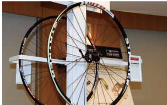
▲WTB圍繞核心技術並提出無內胎兼容系統（Tubeless Compatible System, TCS）的概念，讓WTB的輪圈及外胎之間的結合更完整。
