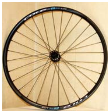
▲Cole 29吋輪組，讓29吋在輻條變長的情況下，張力因花鼓的花耳硬力變大跟著增加，獲得不少好評。
