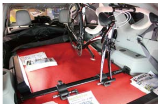
▲車內專用的攜車架，以一支橫桿固定到車內，再以前叉鎖上即可，不過後輪可能還是要自行固定一下會比較穩固。
