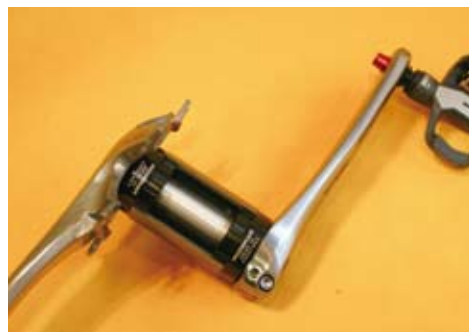
▲Woodman的BB蓋，為Shimano的標準尺寸，專為轉接BB30為24mm專用。
