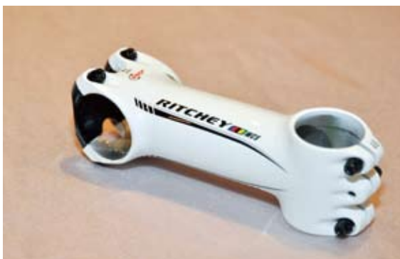
▲ Ritchey wcs c260° 豎管，與車把手的接觸弧度達到 260°，擁有絕佳的包覆性，減少鎖固扭力。
