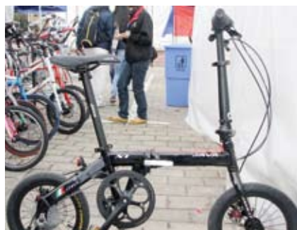
▲JAVA新推出裝配變速及碟煞的折疊車。
