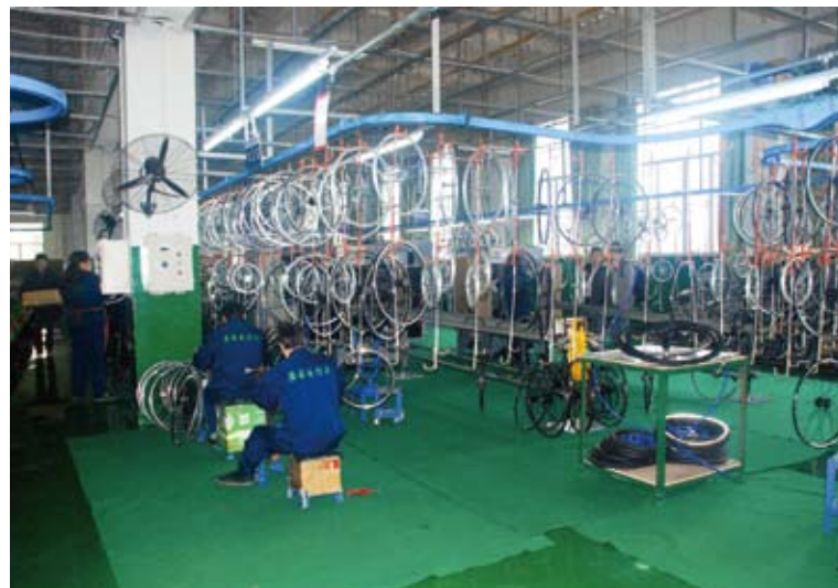
▲自動化的輪圈組裝線。
