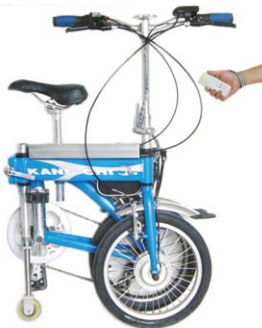
▲透過「無線遙控輔助移動」裝置，達到折疊後車體自動移動的目的。
