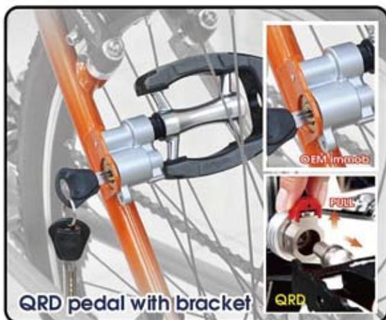
▲QRD快拆踏板可裝在前煞車夾器，或直接固定在後上叉。
