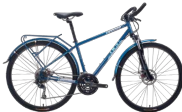
▲Laadist旅行車的貨架與車架焊死，使用更加牢固。
