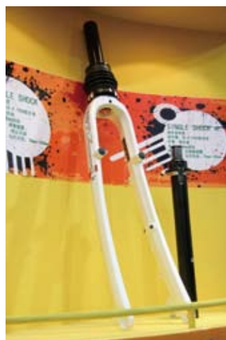
▲RST Single Shock鎂合金材質,彈簧避震,預壓可調,性能更穩定。
