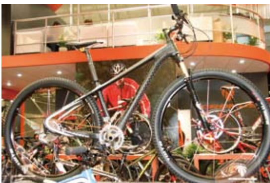
▲凱路仕Cronus展出Genesis 29吋大輪徑XC車款，碳纖車架搭配SRAM XX，車架重1,369g，成車重10kg。
