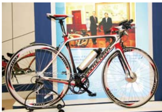
▲飛鴿推出平把電動公路車款，前驅馬達，電池置於車架下管。
