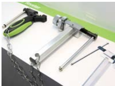
▲KMC除了原有針對車店設計的打鏈器之外，現在也推出適合車友使用、較平價的打鏈器，單速到11速都可用，兩段式軸承。
