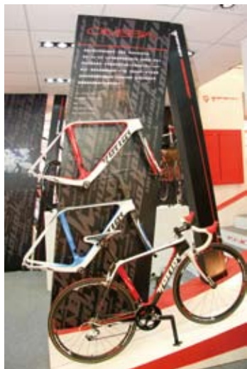
◀Motion魔迅OMEGA碳纖公路車架,採用Toray M601k碳纖達到輕量與剛性的訴求,不對稱下叉,PF BB30系統,重僅850g。
