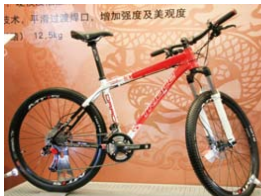
▲Triace展出龍年紀念款山地車Ralord T710，採用3x10s變速系統，6061鋁材質液壓成型車架，整車重量12.5kg。
