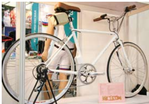
▲英仕奇展出鋁車架的輔助電動車，外型簡潔不笨重，充電2個多小時可續航30km。
