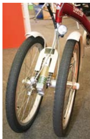
▲獨特的Fun2Top，前輪部份是2個車輪的結構，並各自上下自由運動，使得在任何不平坦的路面狀況下，始終能保持車體對地面的垂直度，發揮非常穩定的行走性能。
