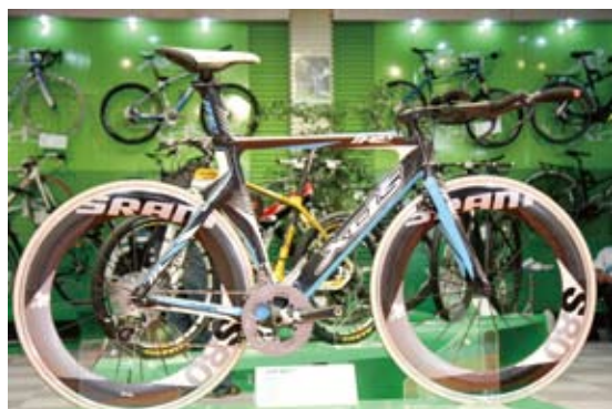
▲喜德盛XDS展出計時車款，採用Sram S80輪組、Force變速系統，以及TRP的TTVOT煞車，能減低風阻。
