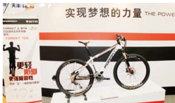
▲FORMAT和WTB合作推出的TCS無內胎整車，採用7075鋁合金DB抽管車架、RockShox Recon Gold TK Sold 100mm行程前叉，WTB Nano 2.1真空胎，Shimano Deore 30速油碟套件。
