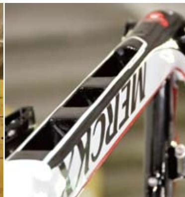
▲ eTT 空氣力學計時車，管型粗獷，下管挖空三個洞，有助降低風阻。
