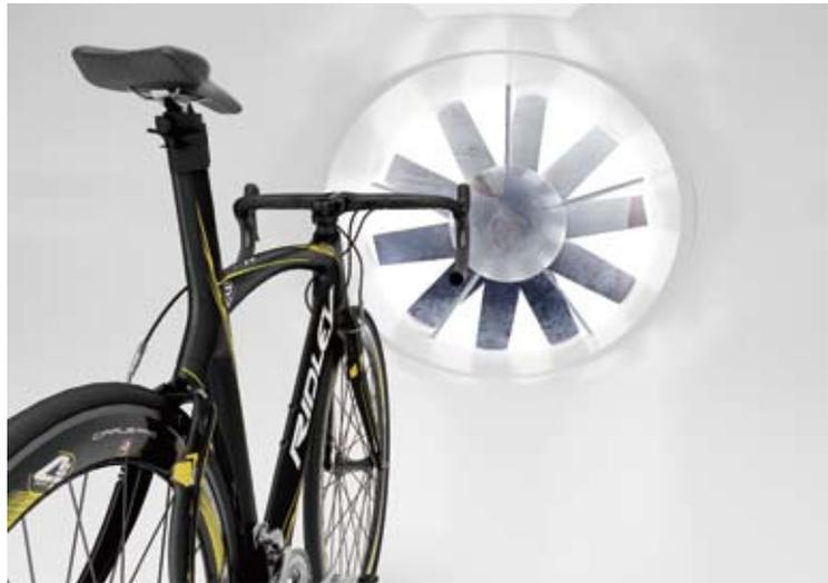
▲ Ridley 透過風洞測試不斷精進空氣動力學車款的技術與設計。
