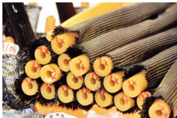
▲所有碳纖管都是從碳纖絲開始在自己廠內編織與成型，車架管非常獨特的採用蠟打樣，外部碳纖維布疊層後，將車架管放入烤箱，利用高溫將蠟熔掉。
