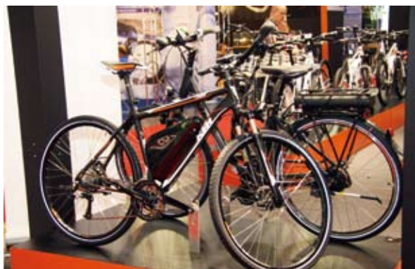
▲KTM e-Cross採用Panasonic電機系統，250W，能騎乘90km，搭配SR Suntour 700C前叉。
