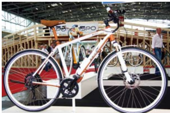
▲ E-BIKE展出的城市運動風格電動自行車，巧妙地將電池塞進下管，讓人幾乎看不出來是電動車。
