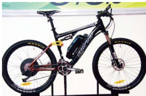
▲永祺展出搭配Green Trans電機系統的雙避震電動車款，48V有很強的馬力讓玩家更輕鬆爬上山，再享受下坡騎乘的樂趣。
