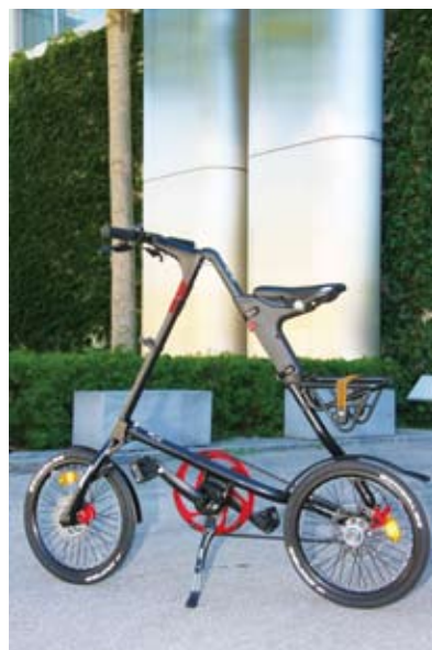
▲ Strida的內變3速車款，車把上看不到變速裝置，全靠五通上的特殊機構作動，只要在踩踏時反向往後踩即可變速。
