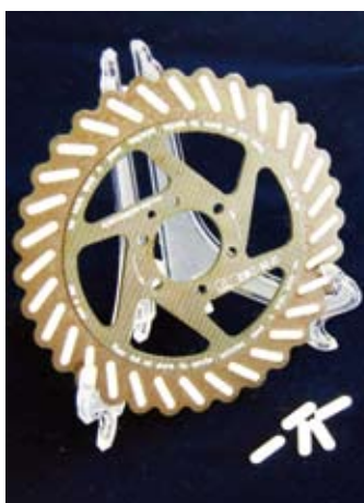
▲亞聯機械展出陶瓷搭配碳纖維材質的碟盤，以碳纖維板為本體，鑲嵌陶瓷片；當油壓煞車作動時，由陶瓷片承受來令片所產生的高溫與磨耗。
