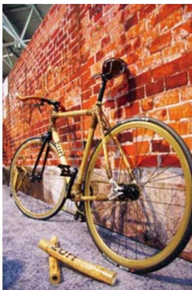
▲獲得BrandNew Award肯定的Zuri竹製自行車，通過剛性測試，彈性好、壽命長，重約9kg，售價2,500歐元。
