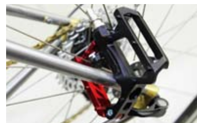
▲XPEDO XCF-10踏板利用本體上的開合機構，讓踏板變身為鎖具。
