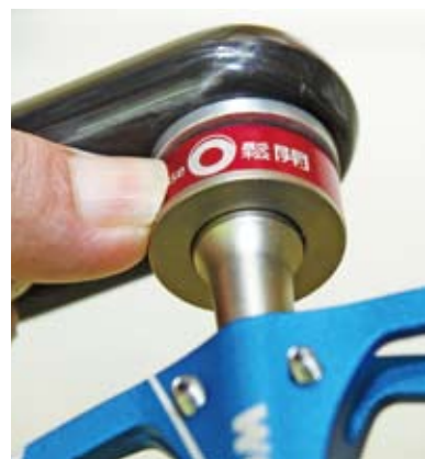
▲QRD-2將卡合定位機構改以圓環型設計，只要將紅色圓環往特定方向輕推即可卸下踏板。
