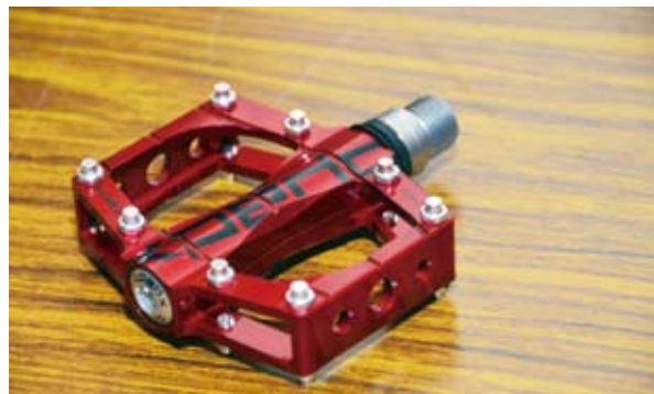
▲維格Xpedo XCF09MC鋁合金擠型輕型踏板，頂端的止滑釘增強止滑效果，踩踏面與腳底接觸面的比例是恰到好處，讓車手施力更為集中，是城市車及公路車使用者的最佳首選款。
