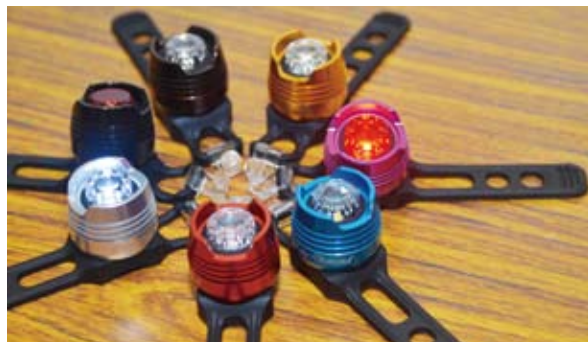
▲登冠Duson的Diamond和Ruby等兩款配件燈分別為白光與紅光，提供恆亮與閃爍等兩種模式，照射幅度達240度，外殼採用鋁合金材質，防水效果更好，水下10cm可達30分鐘，使用兩顆CR2032電池，重量為90g。
