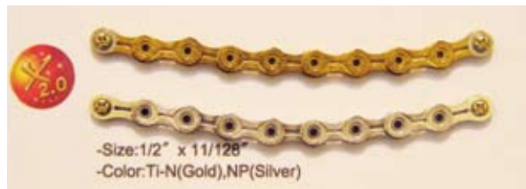
▲桂盟KMC X2.0黃金鏈條採取內外雙橋型設計，不但變速加快，也減少鏈條對齒尖的磨耗；還有對稱性導角設計，除了沒有方向性問題，以及排除齒尖對於鏈條的干擾，傳動瞬間感受扎實的回饋感；外鏈片內節間隙較大，換檔更順暢。
