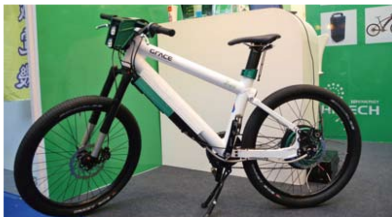
▲Grace雖然保有自行車的外觀，不過其最快速度可達75 km/h，在歐洲屬電動摩托車。
