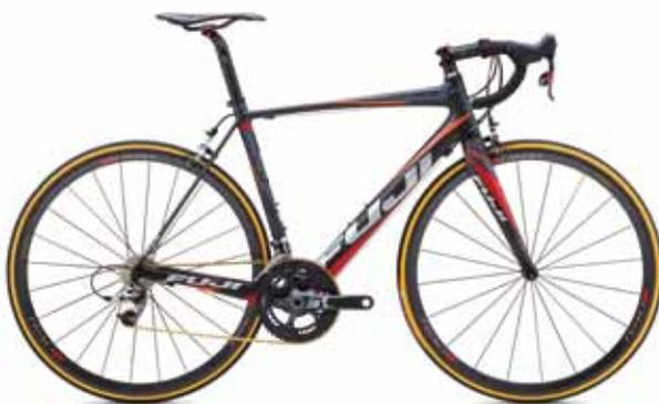
▲Fuji Altamira SL採用C15碳纖維材質，結構更加扎實，擁有錐形頭管、極細後上叉和碳纖為勾爪設計，搭載Sram Red變速系統僅重6kg。
