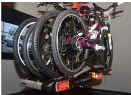
▲Thule Euroclassic G6系列攜車架適用於各種款式的自行車，最多可裝載4輛，並且配備固定架與防竊鎖具，只要輕踩中間的踏鈕，攜車架就能往後90度傾斜，讓你輕鬆打開後車箱取物。
