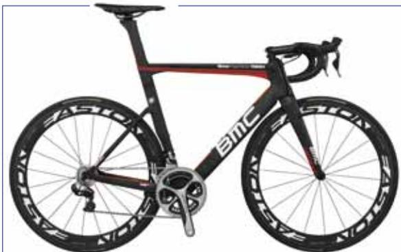
▲BMC TMR01的煞車系統整合於前叉與後上叉，縮小後三小面積，提供較佳的舒適感，整車搭配Shimano DA Di2僅重6.8kg。
