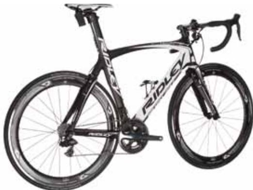
▲Ridley Naoh Fast 1302AM承襲「Fast-Concept」，分別在煞車夾器、前叉與表面塗層技術等部份融入空氣力學的設計理念，希望在騎乘中可以減少的空氣擾流與阻力。
