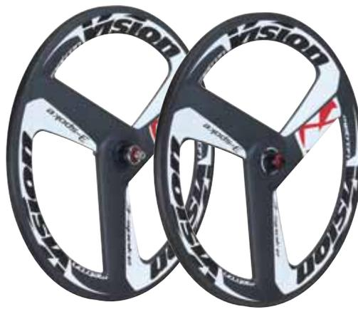
▲Vision 3-Spoke三刀輪組，框高60mm，適用於Tubular款式，採取空氣力學設計理念與經過風洞測試，獨立斷面設計可以解決側風干擾的問題，花鼓為陶瓷軸承，重量1,850g。
