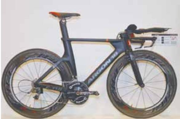
▲Argon18 E118三鐵計時車同樣具備空氣力學與整合式煞車系統等設計，車把手可調整的高度範圍達10cm，讓騎乘者找到最適合姿勢，可相容Di2和EPS變速系統。
