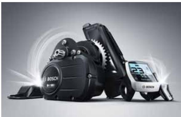
▲Bosch新款電控系統，提供Turbo、Sport、Tour、Eco和Off等五種模式與步行模式，附加USB可供手機或MP3充電，輔助時速可達每小時45km，電池可選400wh/300wh，重量2.6與2.4kg，充電時間3.5和2.5小時。
