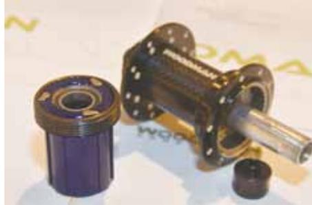
▲Woodman花鼓棘輪座中的三個勾爪可以同時入爪，讓力量平均分散，傳輸力量完整，使用壽命更長久。
