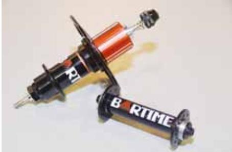
▲Bartime RS100加入同步環設計，讓勾爪可以同時咬合，增加耐用性；採用高強度不鏽鋼軸承，搭配5個培林讓花鼓擁有更好的側向剛性，加裝墊片可相容11速。
