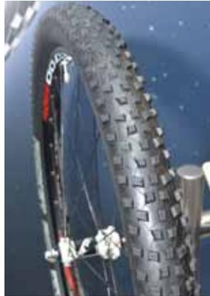
▲Schwalbe Rocket Ron減少15%的滾動阻力，加上全新輪胎側壁，可於Tubeless Ready。規格包含26、27.5和29吋等款式。
