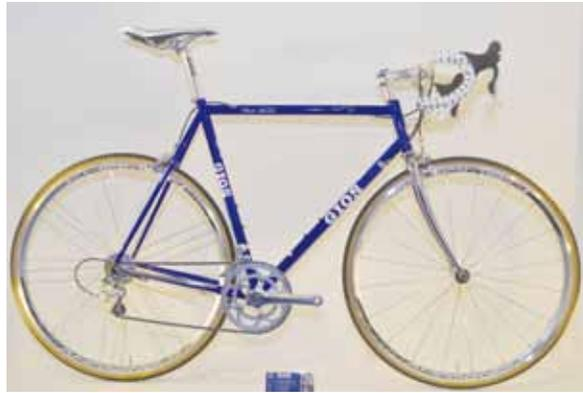
▲為了慶祝65週年，Gios推出紀念車款，採用Cr-mo材質，上管選刻上義大利國旗，後煞車走隱藏式設計，採用Tig焊接，將自行車最傳統風味表露無遺，整車9.5kg。
