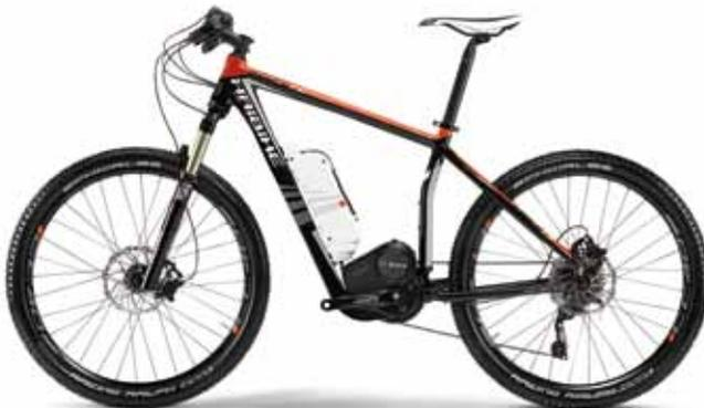
▲HaiBike XDuro rc電動登山車將車架幾何縮小，並且針對亞洲人設計，同時與Bosch一起開發出位於五通上方的馬達系統，整車品質保證，強調MIG！
