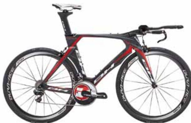
▲BH AeroLight三鐵車可以更換整管，讓騎乘者獲得更多元的選擇，前後煞車系統為隱藏式V夾，重約7.7kg。
