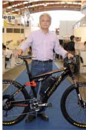
▲永祺車業執行長陳震南介紹26吋XC電輔車，採用後輪驅動250w馬達與48V/7Ah鋰電池，在煞車時可以讓電池回充，依照不同模式可續航40-80km，重量23.5kg。
