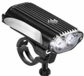
▲Lezyne Mega Drive採用兩顆Cree 1W LED，提供四種適用模式，最高亮度為1,000流明，可續航105分鐘，搭載鋁合金底座，另可加裝在安全帽上方，具備防水、散熱板與USB充電等設計，重量250g。
