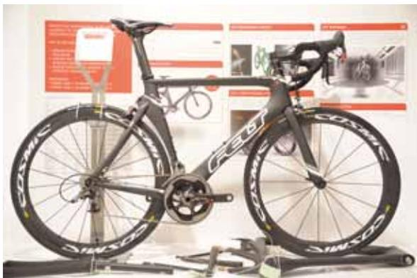
▲Felt AR1公路車以空氣力學為設計基礎，採用UHC奈米碳纖維材質，並且在展場中將車架「大卸八塊」，讓買主可以看得清楚每個角落的形狀與設計。
