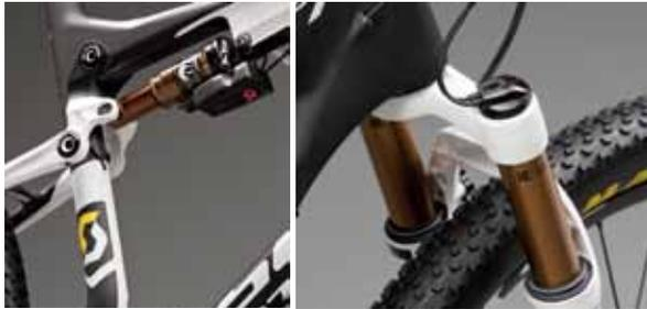
▲Fox Float iCD避震系統透過電子操控達到前後避震器鎖死與全開等功能。
