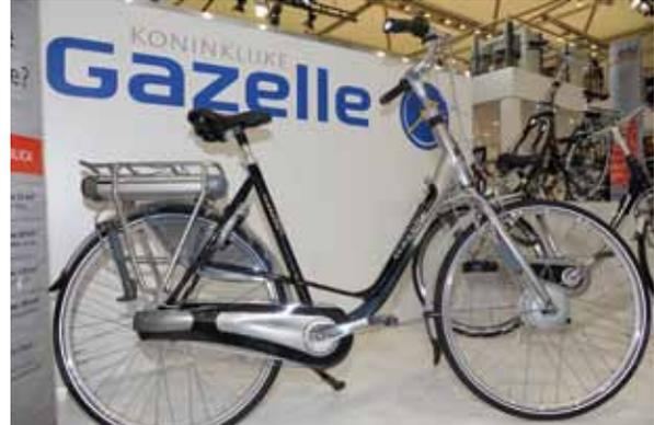
▲Gazelle Orange Pure Innergy，今年增加白金級鋰電池選項，最高續航力達265km，還將鏈蓋直接升成FlowLine II Dynamic chain case，提供強化衝擊保護和更流暢的踩踏效率。
