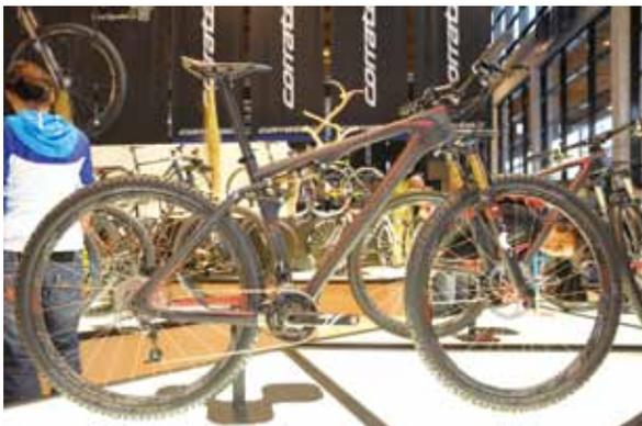
▲Cube Ams 100 Super HPC SLT 29吋登山車採用Super HPC一體成型雙模技術與敏捷的車架幾何設計，以及Sram XX後變與Easton EC90 XC碳纖維輪組，整車僅重9.9kg。
