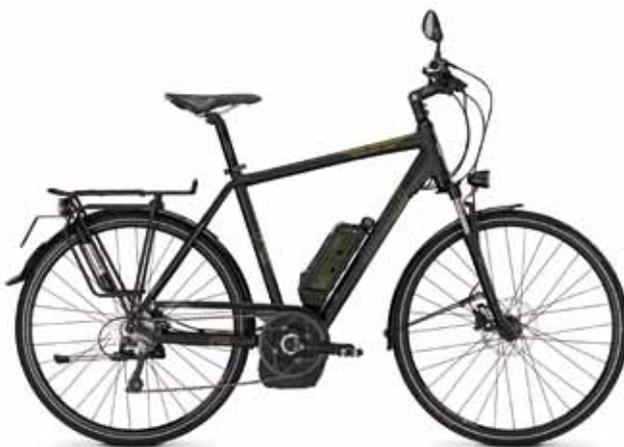
▲Kalkhoff Endeavour BS10搭載Bosch 36V / 400Wh鋰電池、Bosch Speed 36 V / 350 W馬達與Shimano XT 10段變速系統，最長續航力可達135km。
