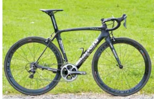
▲Bianchi Oltre XR車架重量相較往年減少35g，擁有流線外型、上下小大的頭管、隱藏式走線與BB30系統等設計。
