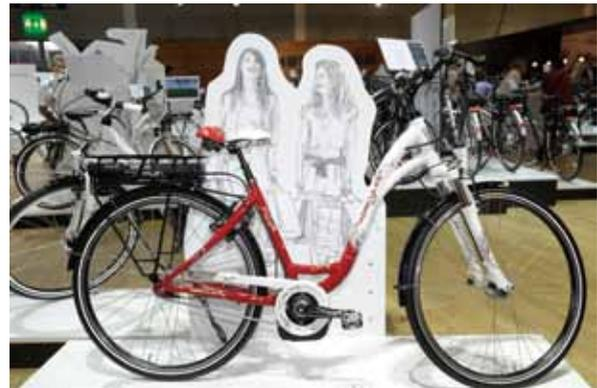
▲Hercules電動車擁有絢麗繽紛的塗裝設計，營造女性優雅時尚的風格，採用Bosch 250W、36V與Shimano Nexus7段變速系統，僅重25.8kg。
