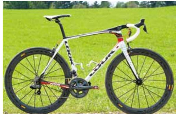
▲Look 675成為率先使用A-Stem的公路車，擁有絕佳的剛性與明確的操控感，騎乘者可獲得±15mm的調整高度，且不需要任何墊圈，既方便又能獲得完美的座艙設定。
