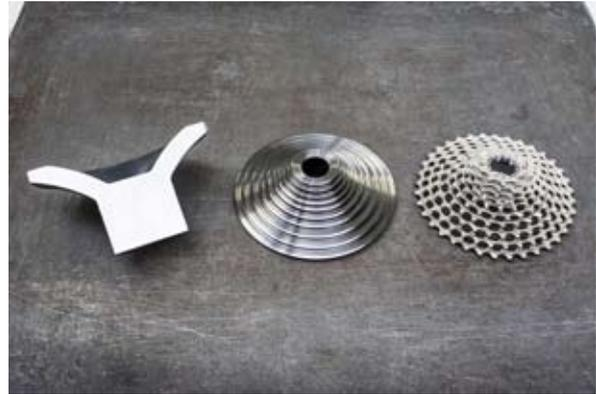
▲後飛輪採X-Dome設計，1-10齒的齒片是由一塊不鏽鋼CNC切削而成，再整合第11齒的鋁合金齒片，重量僅260g。
