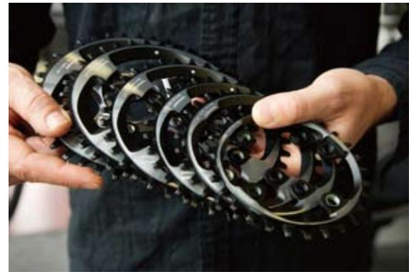
▲SRAM提供6種不同齒數的大盤齒片，完全不需要拆卸曲柄，即可直接替換。
