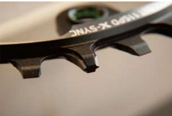
▲厚薄相間的大盤齒片設計精密，就算劇烈震動，也能提供鏈條的高穩定咬合性，不需再加裝導鏈器。
