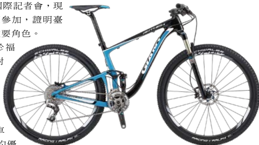
▲Giant Anthem X Advanced 29er 0全避震29吋登山車，車架前三角為複合材質，後三角搖臂為Aluxx-SL超輕量鋁合金，並且搭載專屬的Maestro懸浮系統，給予XC玩家最有競爭力的性能表現。
