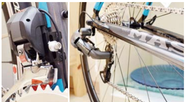
◀▲MASI Evoluzione車架融入多項科技，車架不僅可與Shimano電子變速相容，同時全新開模使用TOS科技，讓車架輕盈且剛性足夠。
