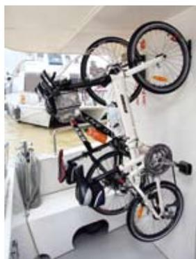
▲船中與船尾都設置吊掛式的置車架，一艘船約可吊掛 5 輛自行車。
