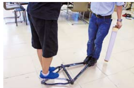
▲設計獨特的後叉，硬度非比尋常，敢於作負重的破壞性測試，即使一個成年男子站在上面也幾乎沒有變形。
