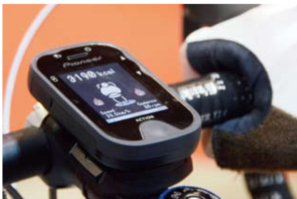
▲更多廠商要加入自行車市場大餅，像是Pioneer也推出Cyclocomputer，不過在安裝上有些許限制，僅能使用於Hollowtech、BB86、BB30及PF30的BB規格上。
