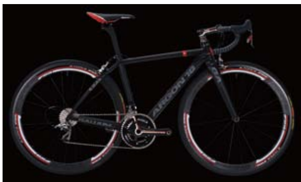
▲Argon18 Gallium Pro頂級競速型公路車採用HM7000碳纖維 材質與HDS概念設計，上半部保持舒適感、下半部路感明確，車 架重量920g。
