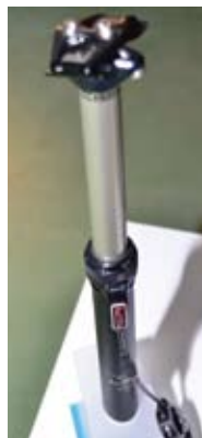
▲KS LEV伸縮座管再進化，出線位置調整至外管束環，作動時管線不會亂跑，安裝時外管束環可以配合管線方向360度旋轉，大幅增加使用便利性，提供100、125和150mm等三種行程，以及30.9、31.6和34.9mm等三種管徑。
