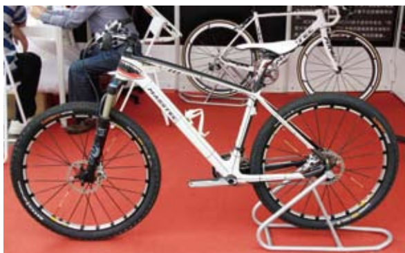
▲臺灣美思克展示包含骨架複合技術 (MFT) 和內壁光滑成型技術 (IBT) 兩項專利的碳纖維山地車。
