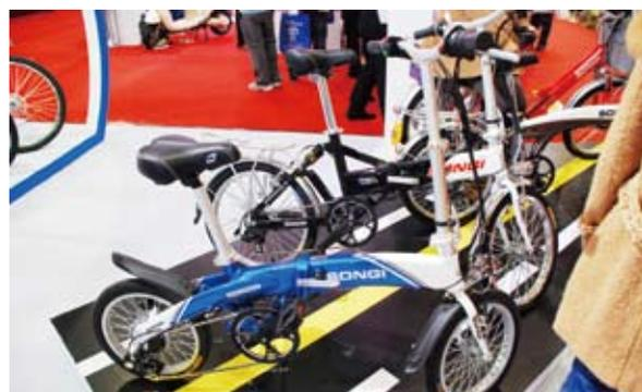
▲松吉的16吋電動折疊車TDR-208Z松豹，個子雖小，卻搭載240W的電機和36V的電池。
