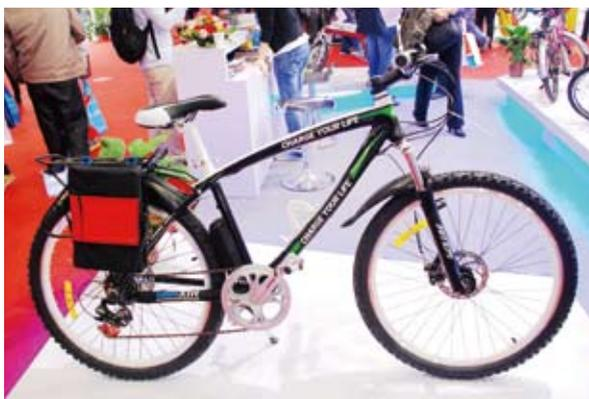
▲科斯特的俊逸3號電動26吋山地車，配備有24V10Ah的便攜式電源。
