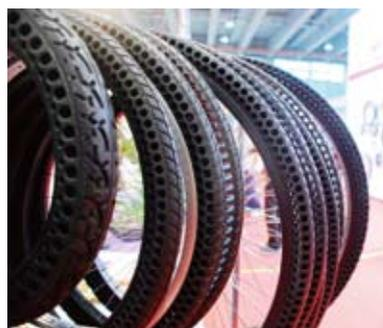
▲耐動仿生學免充氣輪胎以蜂窩減震的原理進行設計，造型吸睛，雖然每條要比一般充氣輪胎重約300克，但無懼漏氣、爆胎所帶來的尷尬和耽誤，每條可達75kg的承重能力足以應付繁重工作，不過目前還沒有開發運動車的規格，只適用於傳統民用通勤自行車。
