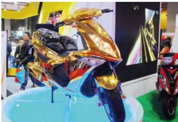
▲眾馳的黃金電鍍版電摩，採用2000W電機、前後碟煞和雙氣後避震，最高時速可達80km，主要用於出口，價格接近萬元人民幣。
