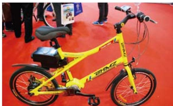
▲天津明珠出品的探戈電助力小輪徑自行車，採用4檔變速，人力和電機助力1:1輸出，並附有電量、速度、變速表、里程顯示的一體化碼表。
