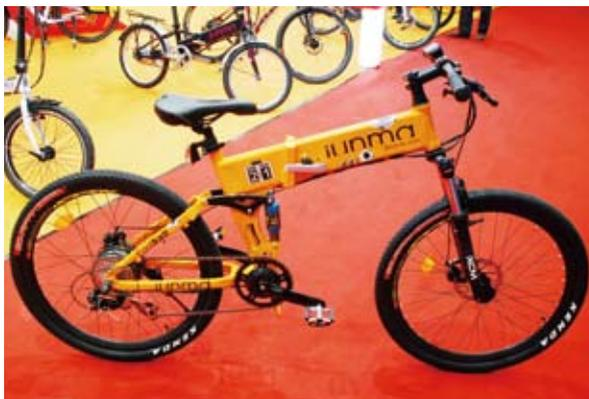
▲佛山駿馬TDE001Z型全避震電動山地車裝備有扭轉矩傳感器，能通過感應曲柄扭轉的加速度來提高電機的動力輸出，起到助力騎行的效果。如果關閉助力功能，通過純電池驅動，可以連續行走40km。
