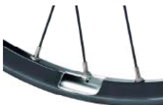
▲改良式無內胎魚眼可以擴大幅條的編織角度，提升輪組整體剛性，更讓輪組輕鬆變為 Tubeless 的規格。
