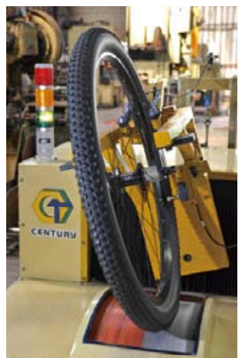
▲全地型輪組測試機可適用各種尺寸的輪組，提供至少 400 種模擬路況。
