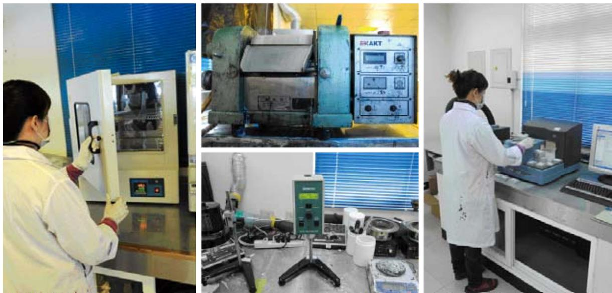
▲卡樂引進示差掃描量熱儀、三滾筒、烘箱及黏度計等設備，在製程上確保達到品質優良。
