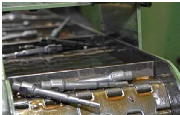
▲完成冷鍛階段的踏板軸心。
