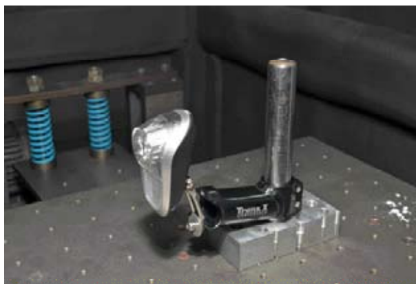
▲ 震動測試機可以檢驗車燈支架的穩固性。
