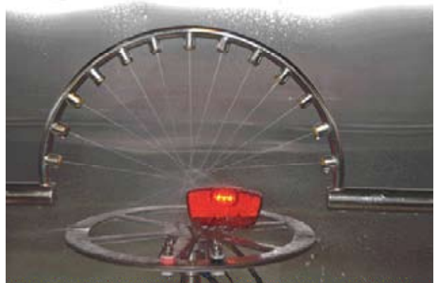
▲ 防水試驗機檢測車燈的防水效能。
