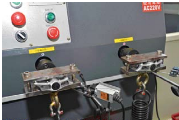
▲ 踏板進行耐磨測試，左右兩邊同步進行。
