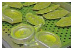
▲因應知名重機品牌要求，透過螢光塗料檢測商品是否有無裂縫。
