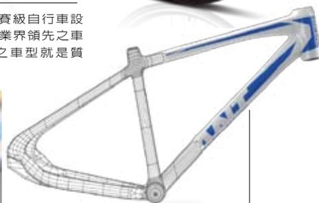
▲ Giant Cycling Science 計算機輔助工程系統 (CAE) 車體外觀設計與結構分析。
