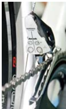
▲Ultegra 6800透過白色尺規量測走線位置，即能完成調整。
