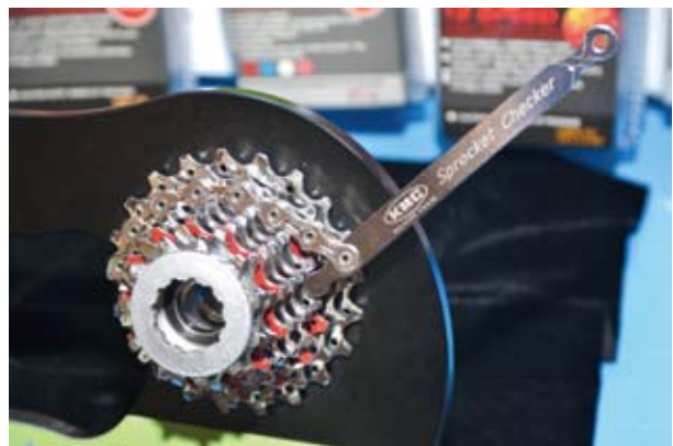
▲KMC 推出飛輪檢測工具，透過定時檢查磨耗程度，確保傳動系統正常。
