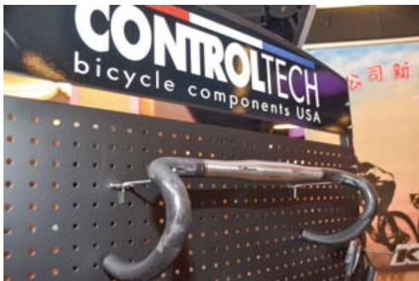
▲Controltech 首度採用碳纖維與鈦合金材質打造公路車把手，透過材質特性取得賽場上的優勢。
