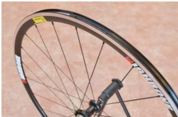
▲Wishbone 輪組採用偏心框與 STB 輻條平衡專利設計，強調每根輻條不會相互重疊，且張力值接近，確保傳輸力量平均。
