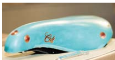
▲百年品牌BROOKS座墊的承托面採用昂貴的真皮，考究的包邊工藝，純手工鋼釘鉗接。
