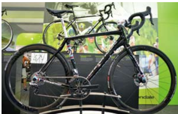
▲Cannondale Synapse碟煞公路車有鋁合金車架及碳纖維車架兩種版本。
