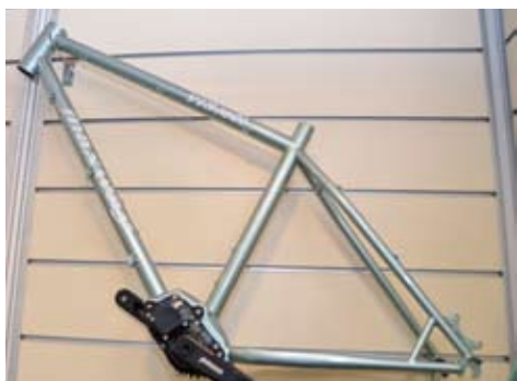
▲一心的Y13M01使用CrMo材質打造，提供27.5吋的登山車使用，同時也特別設計給Pinon的18速內變速使用。
