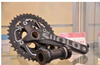
▲浩盟推出符合27.5吋使用的大齒盤，大齒盤數分別為52T及36T。
