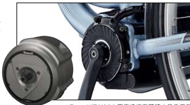
▲TranzX 的 M25 中置馬達擁有體積小且重量輕的優勢，同時馬達扭力佳，是展會中的明星產品，搭配 AGT 系統體積仍獲得許多買主注意。
