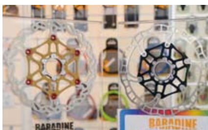
▲永傑的DB-08TP擁有制動力佳的特點，採用外碟片為不鏽鋼，內碟片為鋁合金打造，提供160及180mm選擇。
