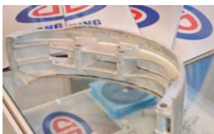
▲將頂與Bosch共同開發，採用6061鋁合金並透過1600噸大型鍛造機及CNC，打造出Bosch馬達使用基座。
