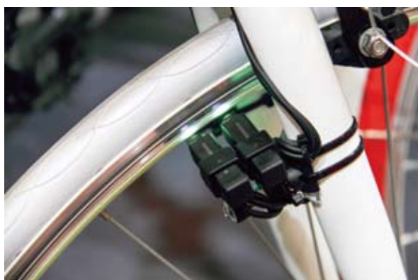
▲RayTrek透過紫外線當照射輪圈上的夜光貼紙，可讓輪圈在黑暗中發光。
