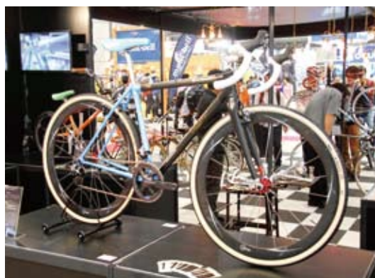
▲ 東洋推出前三角碳纖維，後三角鋼管的複合式車架，提供更優良的路感。
